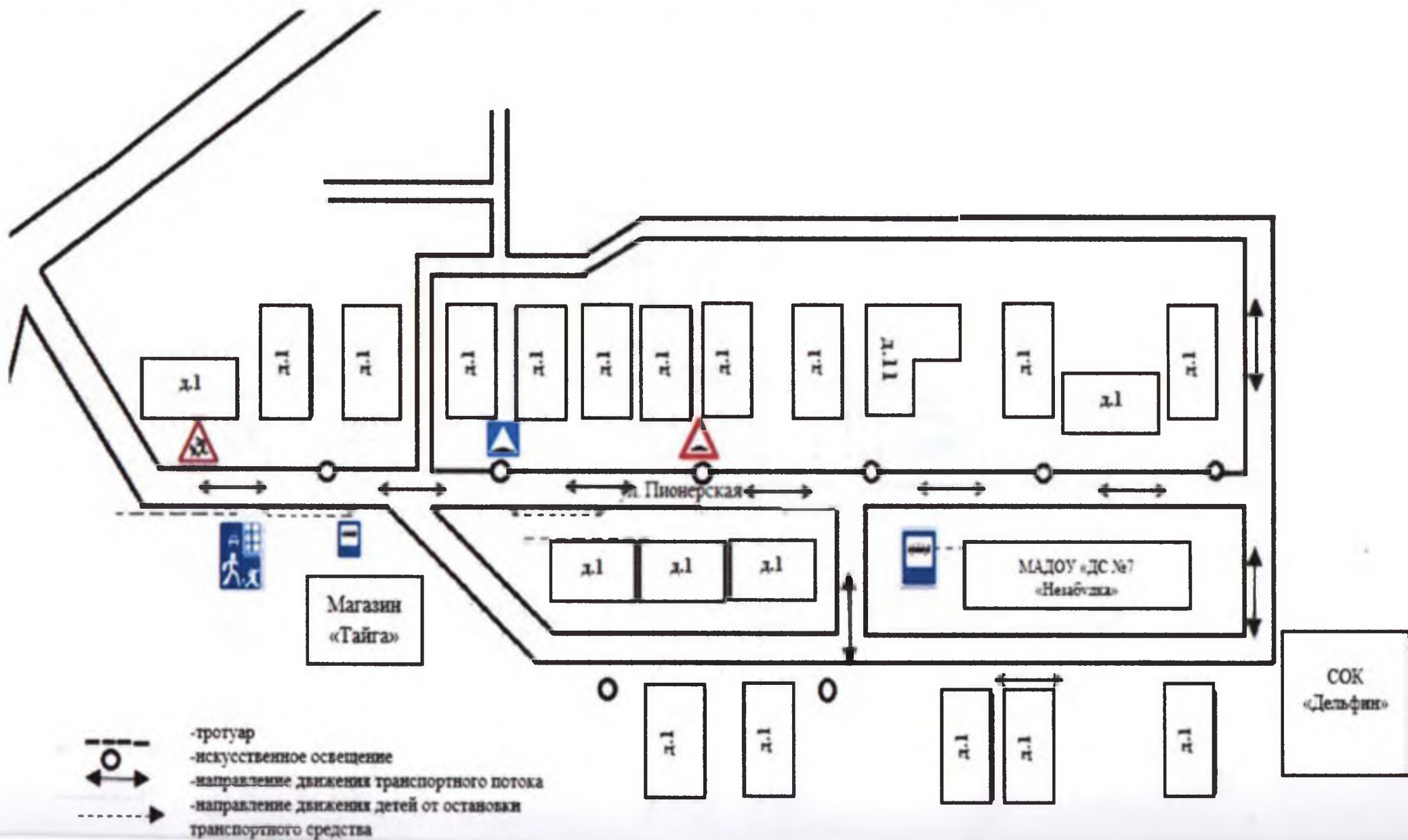
2.Схема организации дорожного движения в непосредственной близости от образовательного учреждения с размещением технических средств организации дорожного движения, маршрутов движения воспитанников и расположения парковочных мест.
